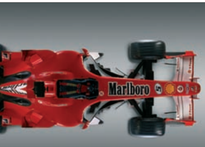
• Vista dall'alto, la Ferrari 2006 mostra tutta la sua compattezza. Il motore è un otto cilindri a V da 2.400 cmc.
